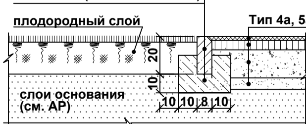
Узел сопряжения тротуара, отмостки из плитки с газоном (в уровень) 1:20
